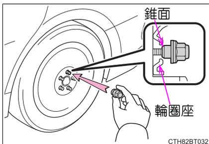
用鋁合金輪圈來替換鋁合金輪圈時，旋緊車輪螺帽直到墊片輕微接觸到輪圈。
