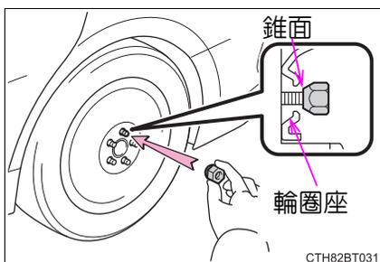
用鋼圈來替換鋁合金輪圈時，旋緊車輪螺帽直到錐面部位輕微接觸到輪圈座。
