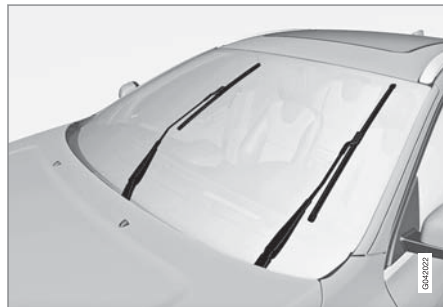
位於維修位置的雨刷片。
